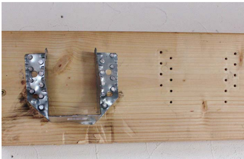
Erste Demontageversuche beim mit Ankernägeln befestigten Blechformteil führten lediglich zur Beschädigung des Materials (links). Das mit Balkenschuhschrauben befestigte Formteil konnte sauber und schnell entfernt werden (rechts) – und kann zudem wiederverwendet werden.
