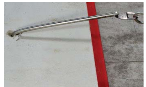
Bild 6 Statische Belastung eines Einzelanschlagpunktes W-VIZ/A4 AP mit großer Verformung
